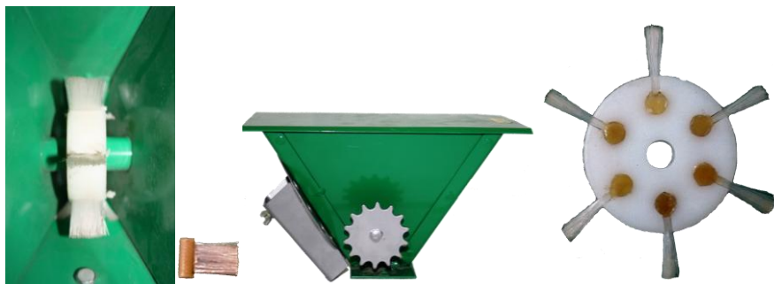
Рис 2. Щеточный высевающий аппарат ЩВА 96/6 (щетка может поставляться отдельно) .
