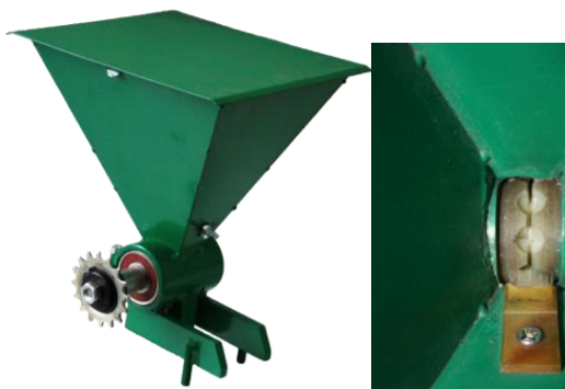
Рис 3. Высевающий аппарат точного высева ВПС 52/1.
